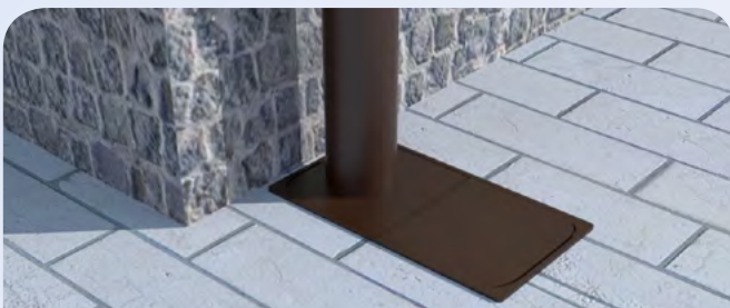
16. Rurę spustową wprowadź w otwór kłapy osadnika, w którym wcześniej należy wyciąć otwór równy średnicy rury spustowej.
